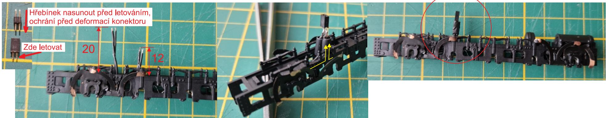
Propojení mezi lokomotivou a tendrem je dodáváno již sletované. Čtyři silnější vodiče jsou určeny pro sběr proudu z kolejí a napájení motoru, čtyři slabší pro osvětlení tendru. Elektrické zapojení je na schématu dole.
